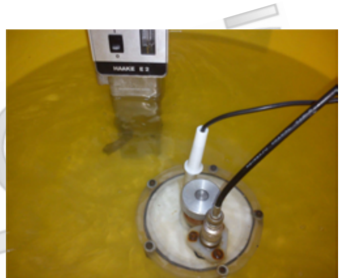
Figura 2. Montaje para simular las condiciones de medida en planta. En este caso se construye una celda totalmente sumergida en el baño termostático de forma de reproducir las condiciones de borde de la leche en una condición real.
