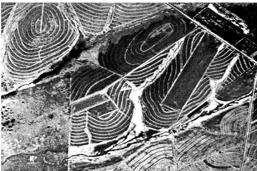
Figura 7. Foto aérea de chacras laboreadas en contorno, con fajas laboreadas de ancho constante y fajas empastadas demarcatorias.
