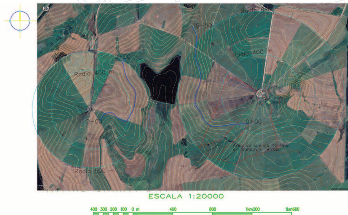
Figura 8. Esta imagen muestra la topografía del área bajo riego, curvas a un metro de intervalo, donde las pendientes críticas están sobre las laderas que vierten hacia el cauce interceptado para la reserva de agua. Se puede observar en color azul las terrazas propuestas para controlar el escurrimiento y volcarlo nuevamente hacia la reserva hídrica, aumentando la eficiencia del uso del agua almacenada y aumentando la cuenca vertiente. Una terraza tiene una longitud de 1.950 y la otra 1.050 metros.
