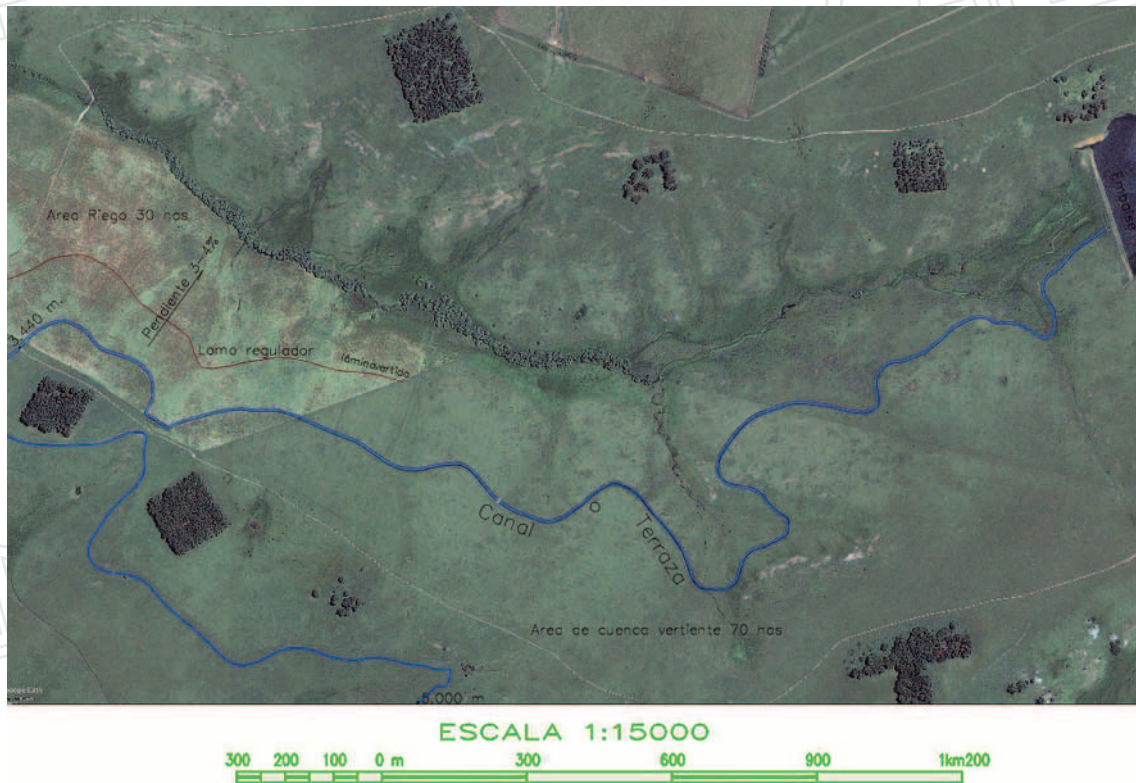
Figura 2: Sistema de riego superficial por desborde de canal, que después de más de 2 kilómetros empieza parte del área de riego de praderas. Las pendientes más críticas en el área oscilan entre 3 y 4 %. El sistema es muy elemental y económico: un lomo regulador a nivel cero, a unos 300 metros abajo regulariza las diferencias de altura de lámina hídrica aplicada.
